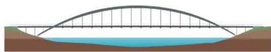
pont M à tablier M intermédiaire half-through arch bridge puente M de tablero M intermedio Halbtrögbrücke F ponte M a via F intermedia
